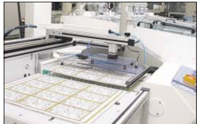
Diese Anlage zur Produktion feiner Leiterbahnstrukturen ist gerade erst auf den Markt gekommen. Fotos: Stefanie August
